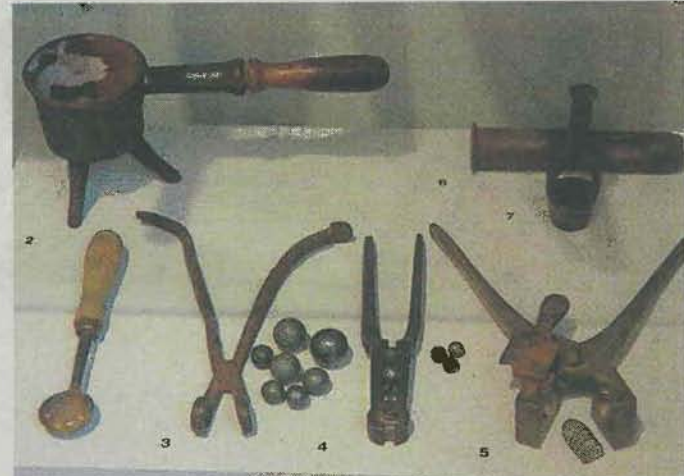
Zubehör: Schmelztiegel und Lochpfeife (hinten), Gießkelle und verschiedene Kugelzangen (vorn).
